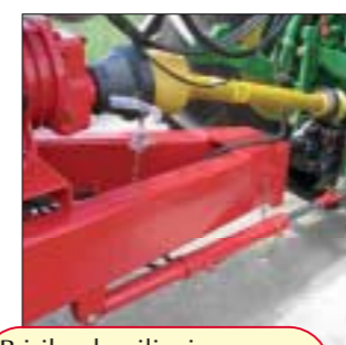
Prisilno krmiljenje TRIDEM podvozja
